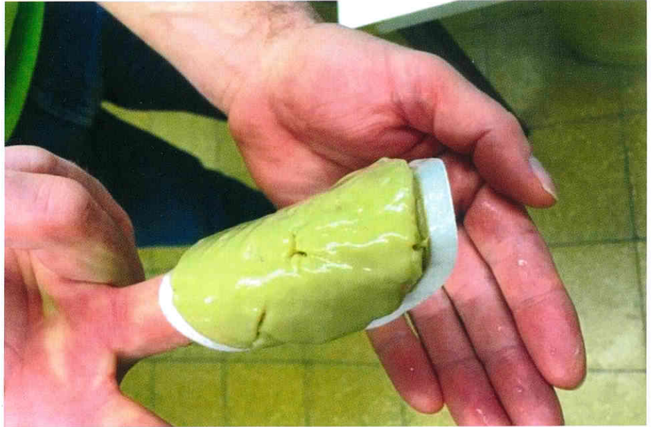
Abb. 4: Bewertung eines ungleichmäßigen Filterkuchens.
